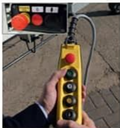
Sistema proporcional de accionamiento del carro
