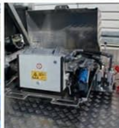
Sistema accionamiento 230 V E- DRIVE con bomba gemela
